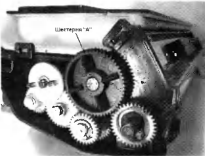
Рис. 8. Вид бункера тонера-девелопера со стороны передаточных шестерен
